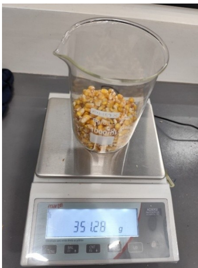
Figura 7 – Pesagem de grãos de milho em laboratório para estimativa do peso de mil sementes (PMS).
