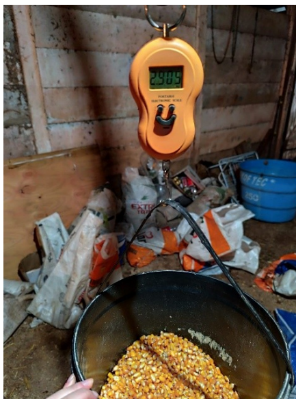
Figura 6 – Procedimento de pesagem dos grãos de milho, utilizando balde previamente tarado e balança eletrônica, para estimativa da produtividade.
