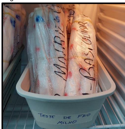
Figura 7 – Início do teste de frio na BOD.
