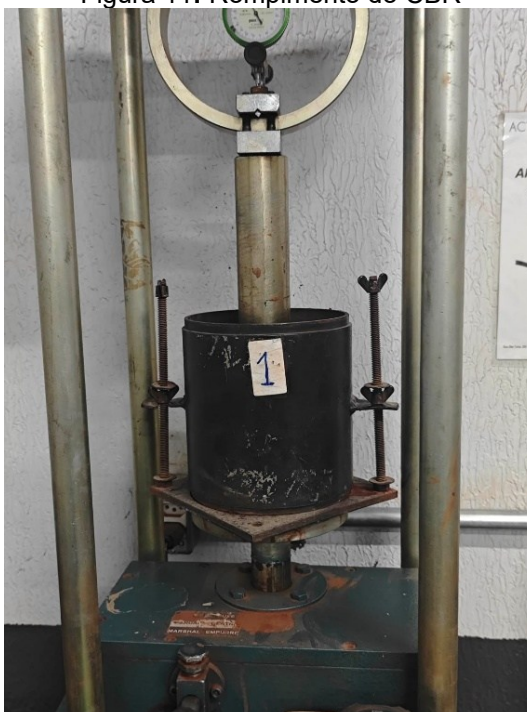
Figura 11: Rompimento do CBR
