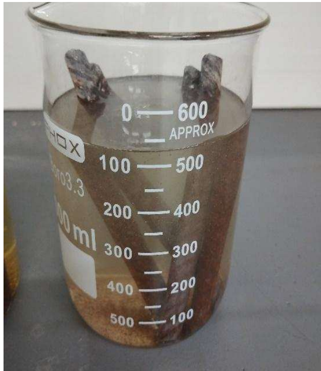
Figura 10. Armaduras submersas em solução de Ácido clorídrico.
