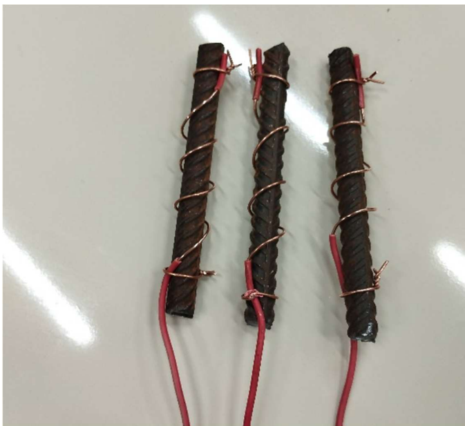
Figura 3. Armadura com cabo anexado de em formato espiral.
