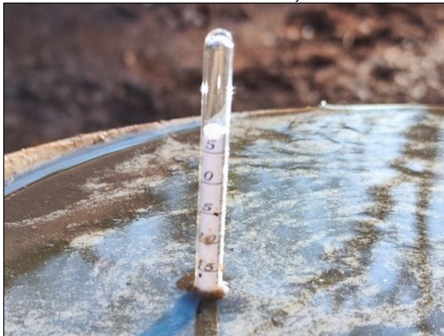
Figura 1 - Determinação da densidade do dejetos líquido de suínos (DLS) através do hidrômetro de Bouyoucos.
