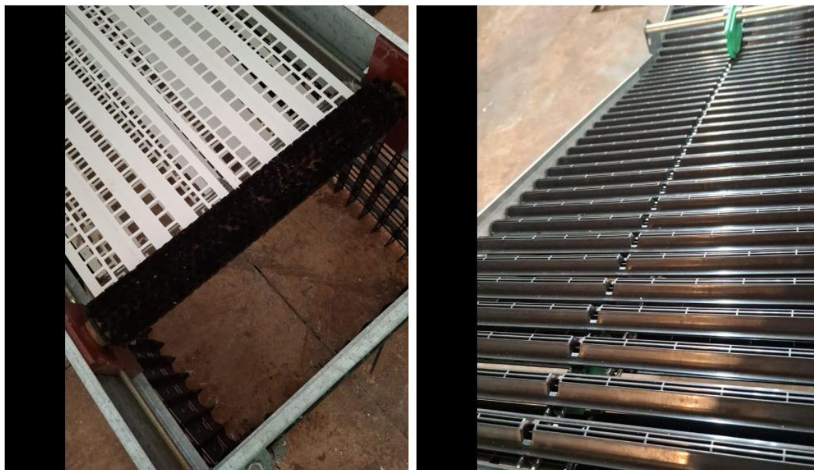
Figura 8 – Ninhos automáticos apresentam estruturas de plástico e metal galvanizado
