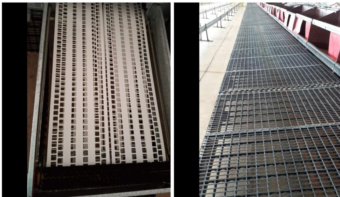
Figura 11 – Estruturas internas e superfície dos ninhos automáticos, evidenciando materiais laváveis e de fácil higienização
