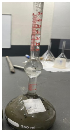
Figura 8 - Frasco Le Chatelier com amostra, volume final.
