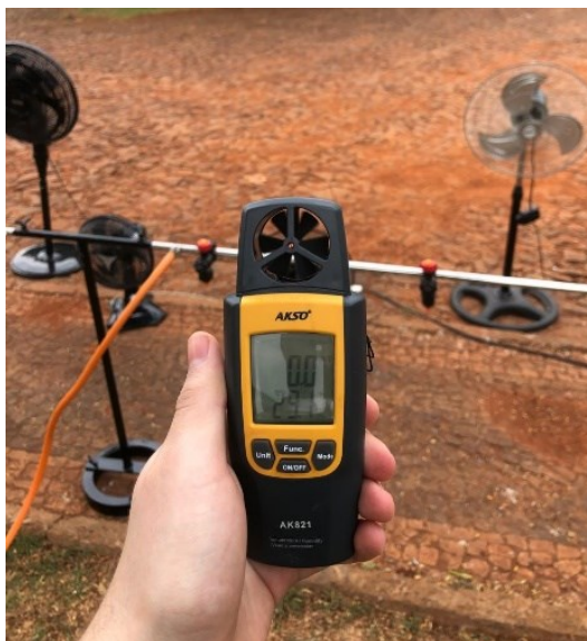
Figura 4 – Medidor de vento demonstrando a ausência de ventilação
