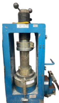
Figura 10 - Prensa hidráulica com corpo de prova
