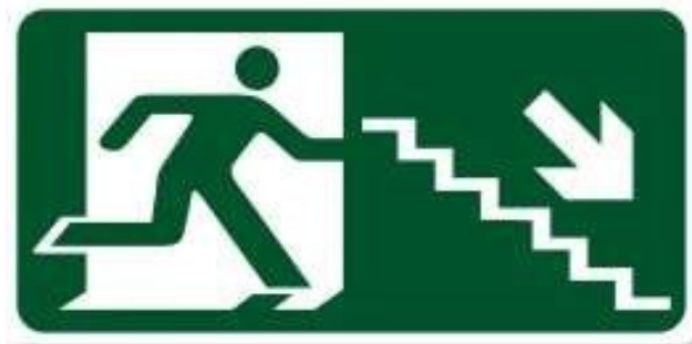
Figura 11 – Exemplo de sinalização de orientação e salvamento.
