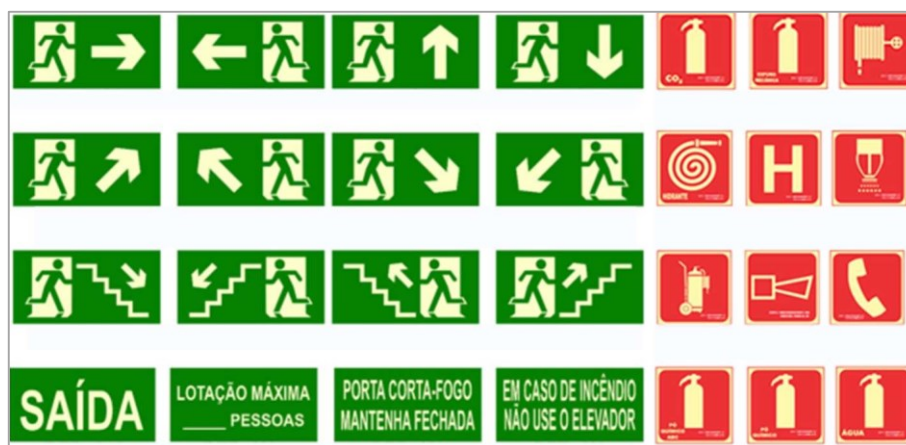
Figura 6 – Sinalização de emergência.
