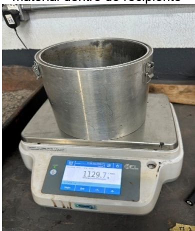
Figura 13: Pesagem do material dentro do recipiente
