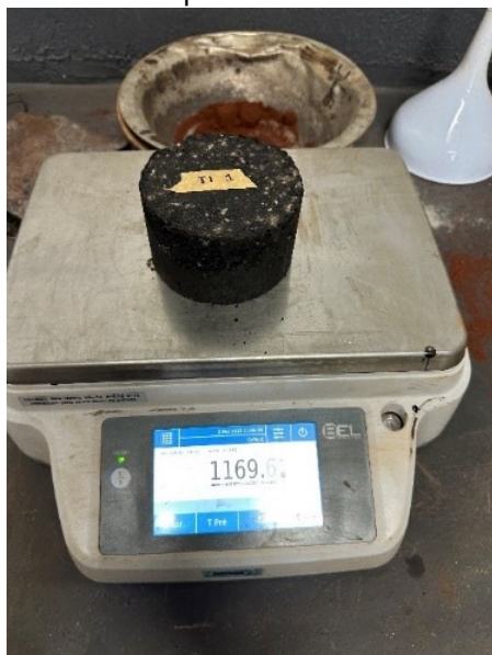
Figura 11: Pesagem do corpo de prova com superfície seca
