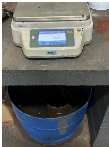
Figura 12: Pesagem do corpo de prova submerso
