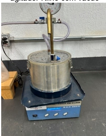
Figura 14: Recipiente no agitador Kline com vácuo
