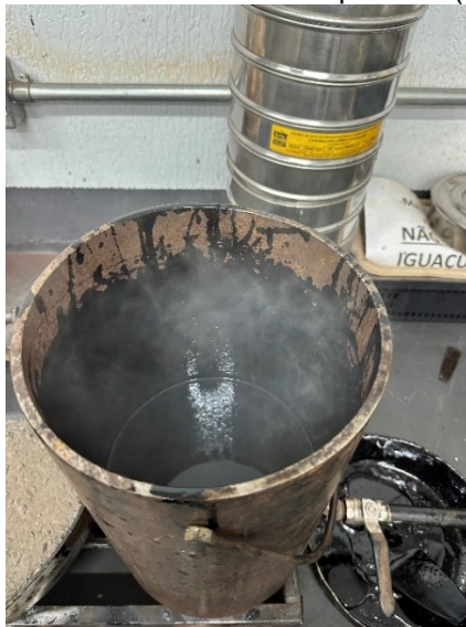
Figura 5: Cimento asfáltico de petróleo (CAP).
