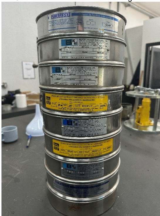
Figura 10: Peneiras utilizadas ensaio de granulometria.
