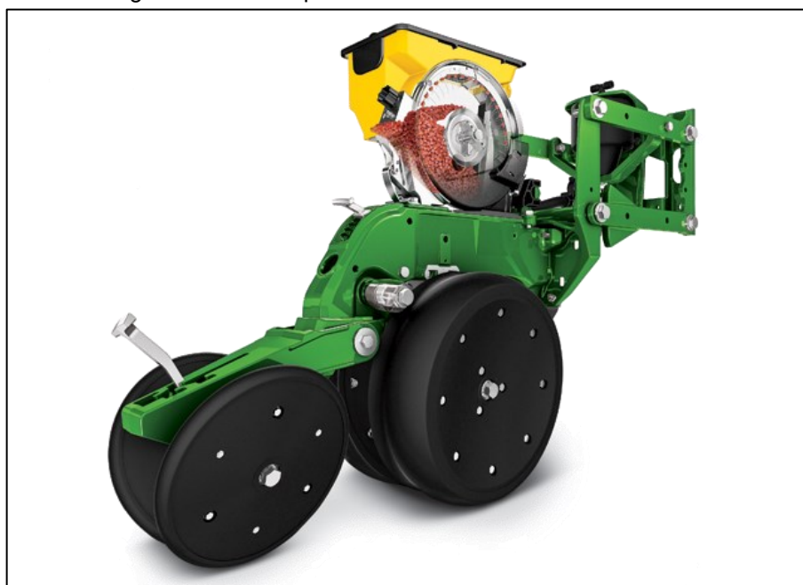
Figura 1- Sistema pneumático da John Deere serie 1100.
