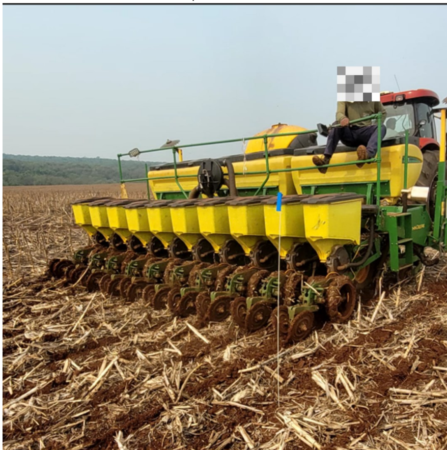
Figura 3 - Plantadeira John Deere série 1100 ano 2019, equipada com sistema de distribuição pneumático vertical.
